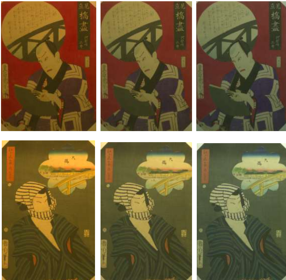
Figura 4. Imágenes (500 lx) de los dos Ukiyo-e bajo los iluminantes LED V1 (izquierda), B3 (centro) y B5 (derecha), con CCTs de 2724 K, 4103 K y 6598 K, respectivamente (Tabla 1).
