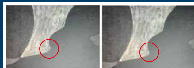
▲ Figura 3: Detalle restauración esquina. Izquierda sin restaurar, derecha restaurado fotónicamente.
