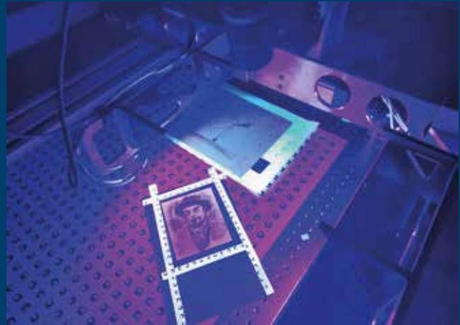
▲ Figura 6: Configuración del sistema de toma de fotos para cuadros y láminas con radiación UV.
