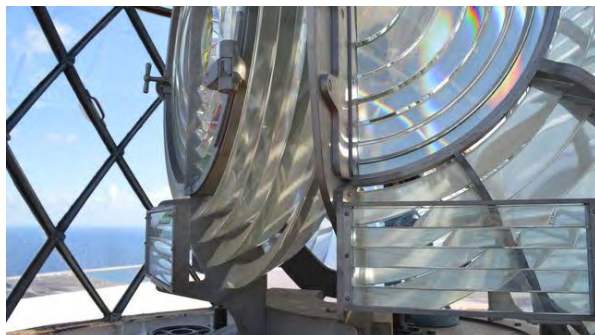
Lente supletoria aerofaro marítimo. Faro de la Isleta (Las Palmas). 2015.
