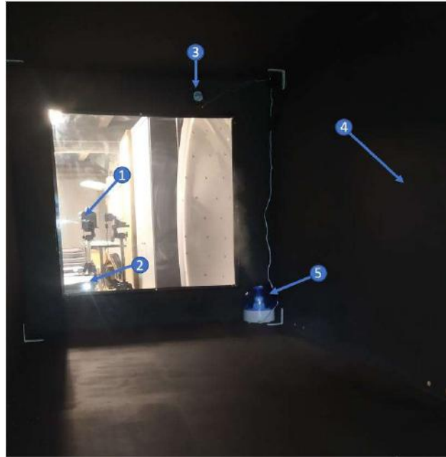
Figura 5: (1) Lumicam 1300, (2) Proyector (Casio X.15-A251), (3) Luxómetro 1, (4) Cámara de humo, (5) Humidificador, (7) Luxómetro 2, (8) Objetivo, (9) Fuente (10) Lente de metacrilato.
