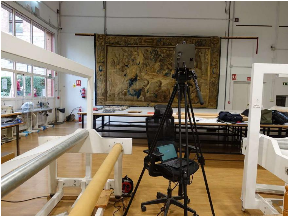
Figura 3. Montaje de medida con el espectrorradiómetro 2D R-510 de un tapiz de gran formato.
