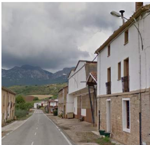
Ejemplo de vial con brazos con inclinación y luminaria con posibilidad de inclinación negativa compensatoria
