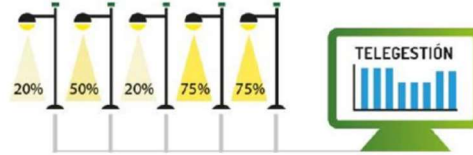
TELEGESTION Y MONITORIZACION DE TODA LA INSTALACION
