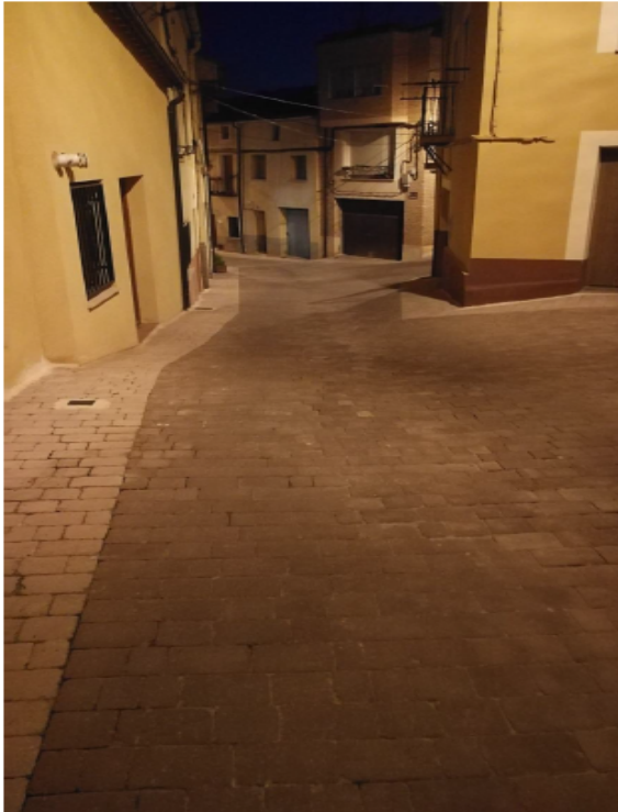
Foto de José A. Martínez mayo 2021 c/ Hospital San Esteban de Gormaz (Soria) para S2 Farol Valentino de SCHREDER 33 w, óptica 5117, 2200 °k Interdistancia 30 m, altura 5 m, ancho de vial 5 m. valores obtenidos con el método de 9 puntos Mínimo 5,5 lux (mayor de 3 lux) Media 9.89 lux (entre 9 y 12 lux) Uniformidad media 55.63% D4 (mayor de D3)
