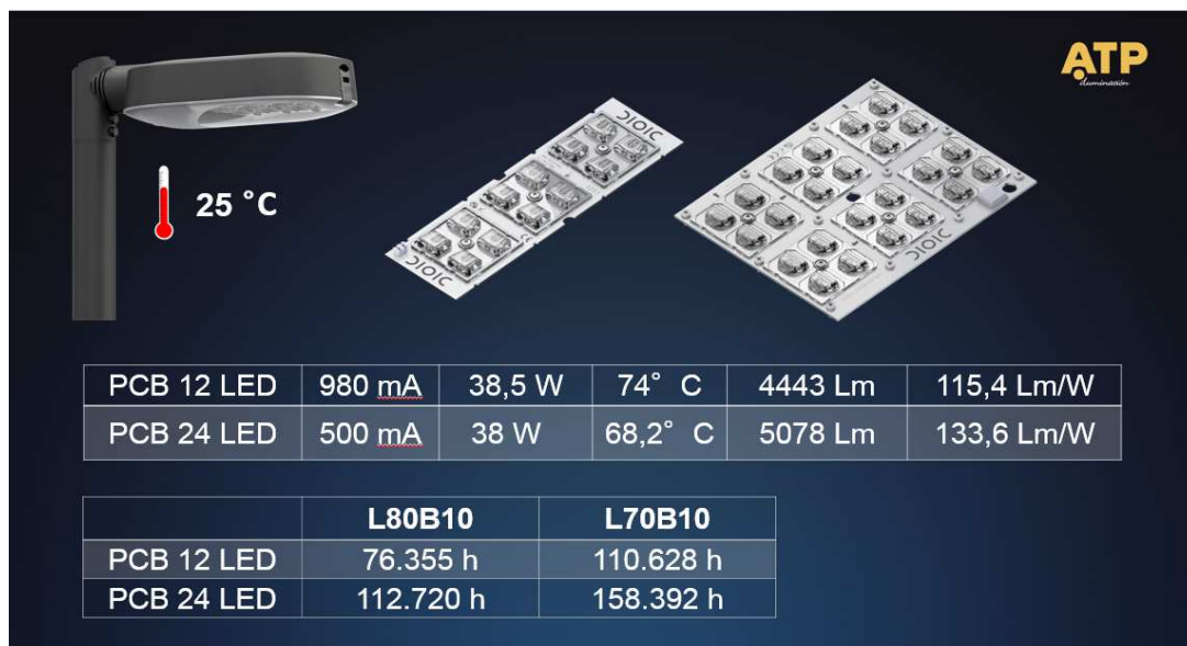
III. Comparativa mantenimiento de flujo dependiendo de la corriente de pilotaje del LED
