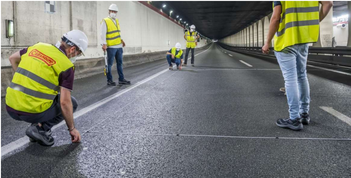
Ilustración 7. El equipo de mediciones lumínicas trabajando para la elaboración de una malla de medición de los niveles lumínicos de la instalación.
