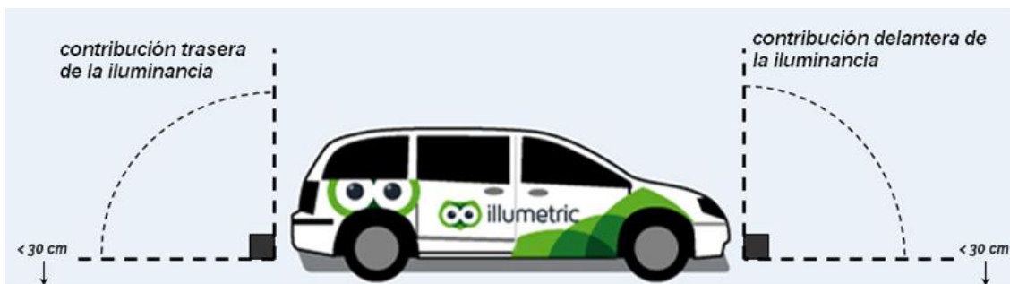
Imagen 2 Representación del método de captura dinámica de iluminancia según Illumetric
