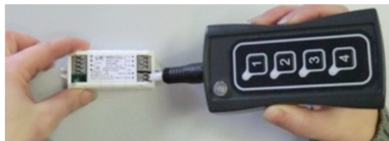
Fig. 3: Programación iMCU con herramienta iCTI
