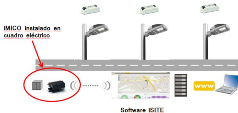
Fig. 10: Reprogramación con PLC (modelo iMICO de Vossloh-Schwabe)
