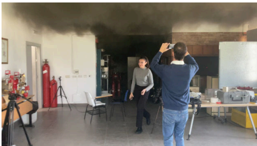
Fig.11.- Propagación del humo en un espacio real en modelo de escenario contenido
