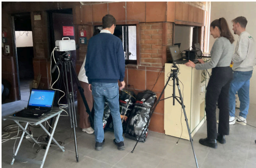
Fig.10.- Ensayo de validación óptica del comportamiento del humo en un espacio real.
