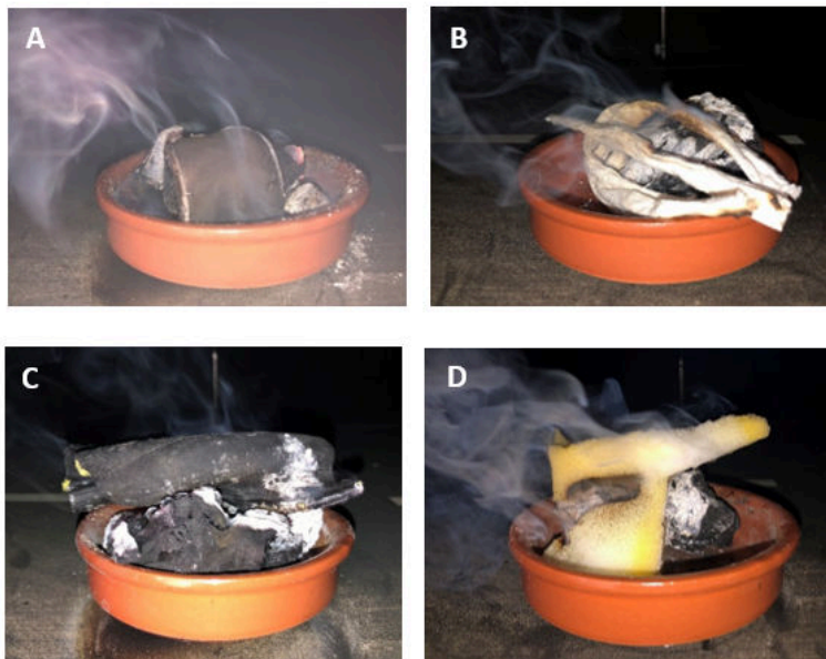
Fig. 8.- Generación de humo para los materiales seleccionados: madera (A), algodón (B), caucho (C) y poliuretano (D).
