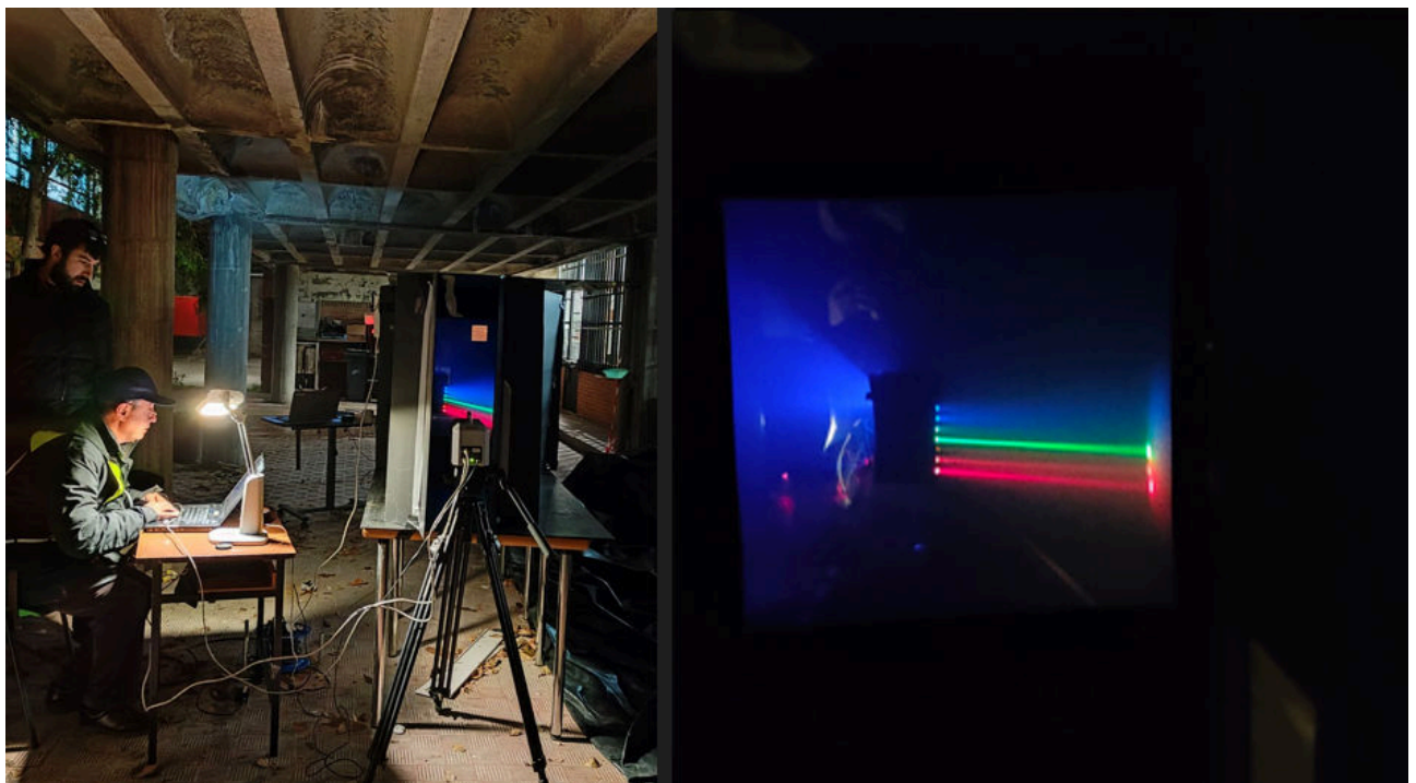
Fig.4.- Sistema multispectral de caracterización de humo
